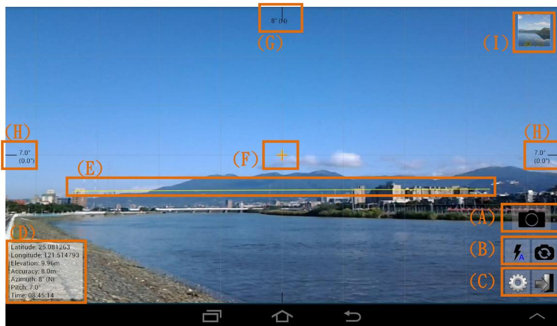
如同一般照相機的程式，開啟軟體後會進入相機預覽的畫面。螢幕上方中間會顯示方位角資訊，左(右)方中間會顯示仰俯角與(水平)偏移角資訊，左下方則顯示 GPS 資訊、方位角、仰俯角與時間等；螢幕右下方有五個按鈕，
